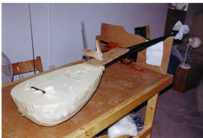
Pegado del diapasón (la tapa aún encintada)
