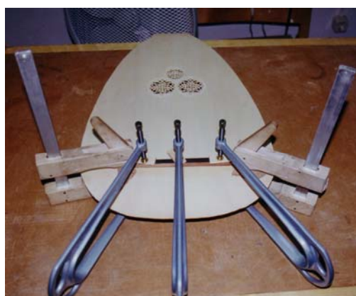
Pegado del puente
