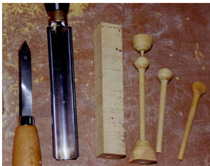
Las fases del torneado de las clavijas
